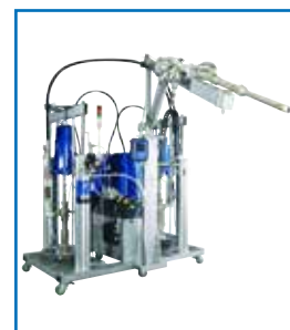
Machine de dosage pour produits pâ- teux, gros débits Hgh volume metering system
