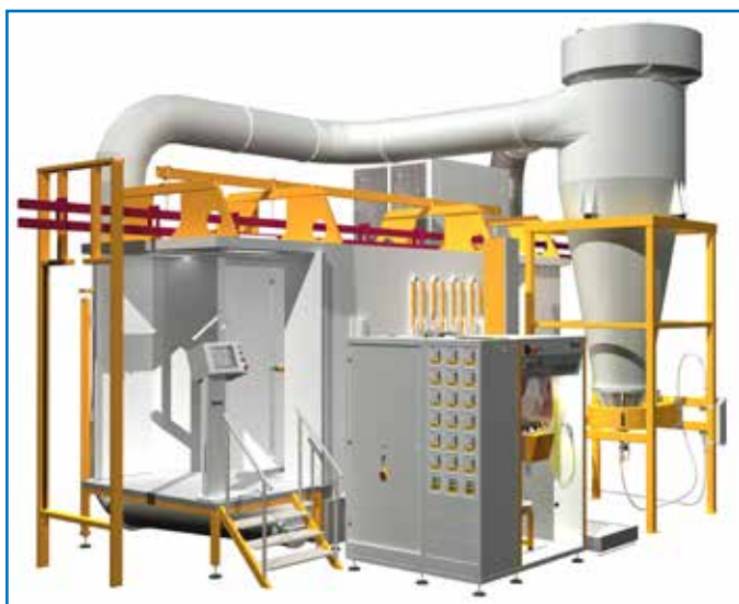
Installation automatique de poudrage Automatic booth system
